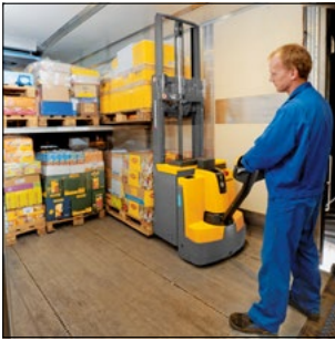
Carga simultánea a dos niveles de un camión
