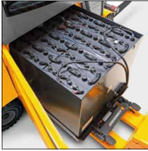
Cambio de batería por el lateral
