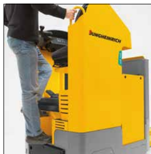
Acceso seguro mediante peldaño bajo y estribo
