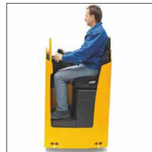
Posición de asiento confortable con placa de fondo regulable en altura en la ESE 220/320
