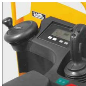
Manipulación de todas las funciones de marcha y elevación con la palanca multifunciones en la ESE 220/320
