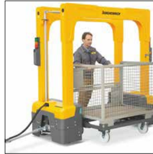
La construcción del pórtico permite extraer la carga empujándola
