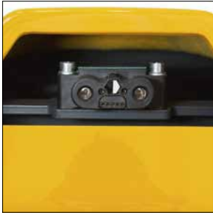
Conexión eléctrica de remolques
