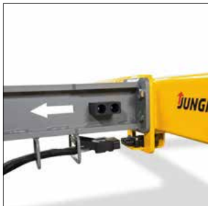
Conexión eléctrica de los remolques (GTE 312)
