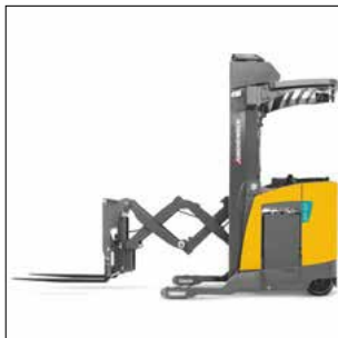
Pantógrafo para apilado de doble profundidad
