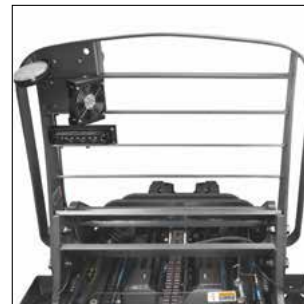
Las mejores condiciones de visibilidad mediante lamas apropiadas en el tejadillo protector
