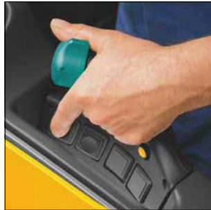
ESD 120: Elemento de mando para la regulación de la velocidad de marcha y la función de elevación
