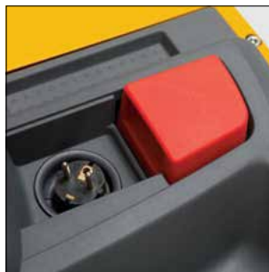
Manipulación fácil de la clavija a red del cargador integrado
