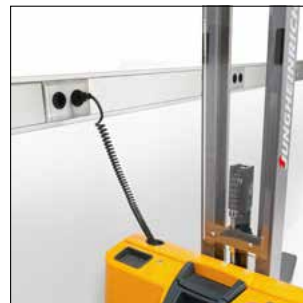
Carga fácil en cualquier toma de corriente de red de 230 V gracias a un cargador integrado
