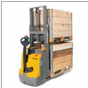
Carga simultánea a dos niveles: Recogida de dos palets super- puestos
