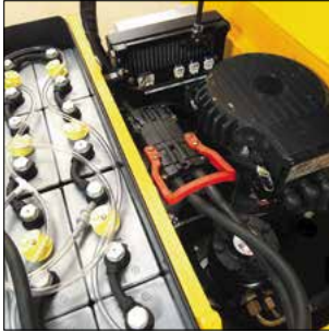
Motor de tracción y de elevación en tecnología de corriente trifásica
