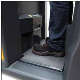
Plataforma de conductor confort amortiguada y ajustable individualmente (opcional)
