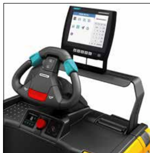
Estribo opcional con terminal de radiofrecuencia WMT 110 (opcional)
