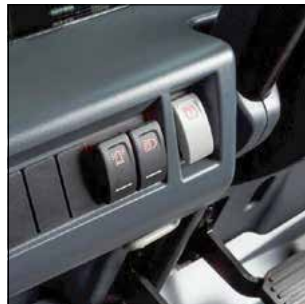
Freno de estacionamiento con accionamiento eléctrico, manejo presionando simplemente un botón
