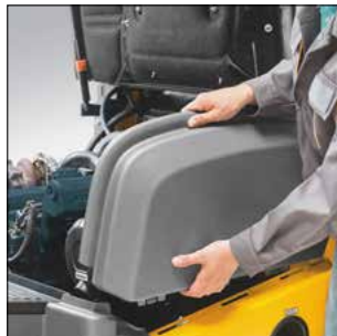
Piezas laterales fácilmente desmontables sin herramientas
