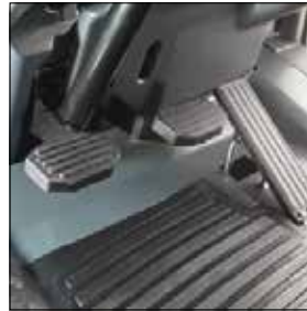
Disposición de los pedales como en un automóvil, con superficie antideslizante
