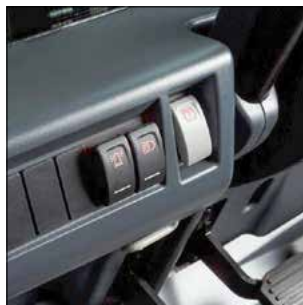
Freno de estacionamiento con accionamiento eléctrico, manejo fácil presionando un botón.
