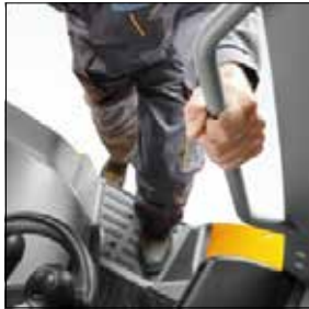
Acceso mediante un peldaño profundo y ancho. Asidero grande y estable, soldado al tejadillo protector
