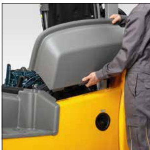
Piezas laterales desmontables fácilmente y sin herramientas
