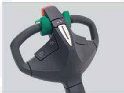
Cabezal ergonómico de la barra timón
